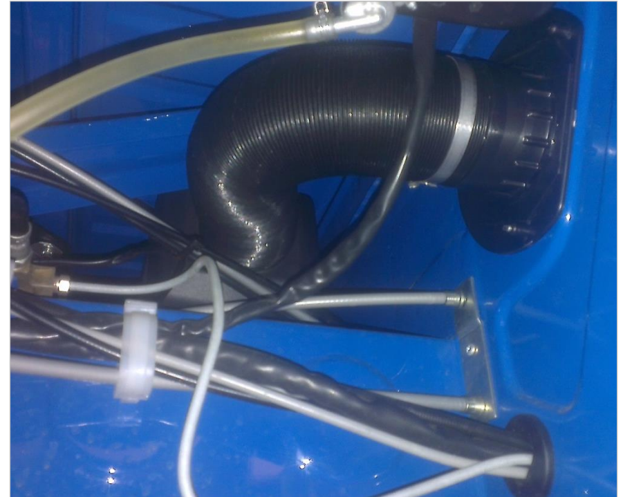
Monter luftslangen og spændebånd ved luftdyse.
